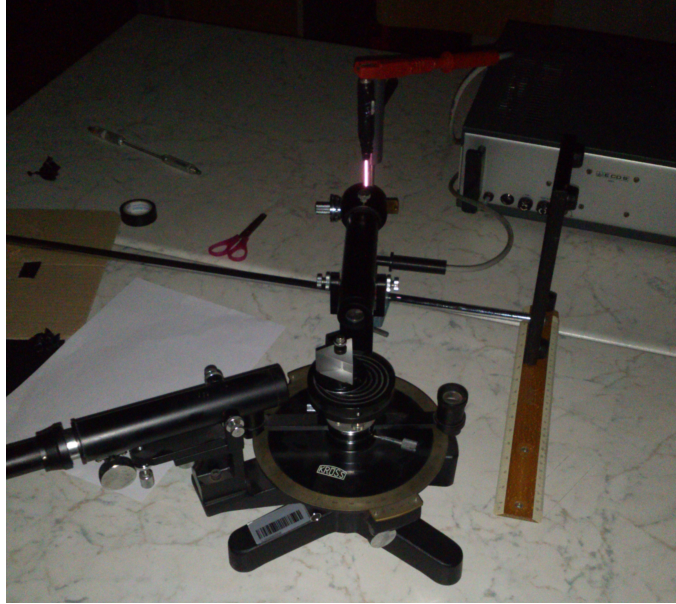
Figura 6: Fotografia dello spettrometro: in evidenza anche la sorgente luminosa schermata.
