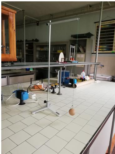
Figura 2: Fotografia del pendolo semplice utilizzato. Questo è costituito da una massetta sferica in legno appesa ad uno stativo da laboratorio per mezzo di un filo di cotone.
