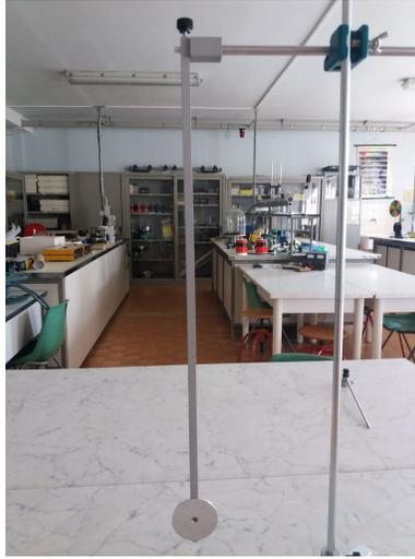
Figura 9: Fotografia del pendolo composto utilizzato. Questo è costituito da un'asta rigida con un foro in prossimità della sua estremità superiore, all'interno del quale passa l'asse di rotazione. Oltre il bordo dell'asta è inoltre presente una vite di bloccaggio. All'altra estremità è invece montato un disco sottile, con la sezione rivolta nella direzione di oscillazione in modo da costituire un bersaglio adeguato per il sensore ad ultrasuoni.
