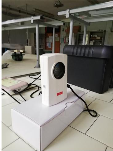
Figura 3: Fotografia del sensore di posizione utilizzato. Questo emette ultrasuoni che si riflettono sulla massetta in movimento e vengono quindi rivelati dal sensore. L'elongazione del pendolo all'istante  $t$ ,  $x(t)$  viene quindi determinata dalla misura dell'intervallo di tempo che intercorre fra l'emissione e la rivelazione degli ultrasuoni.
