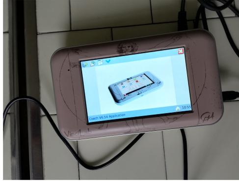
Figura 4: Fotografia della piattaforma VinciLab. Ad ogni *run* di raccolta dati, questa acquisisce 500 misurazioni con una scansione temporale di  $0,02\text{ s}$  su un intervallo di  $10\text{ s}$ .
