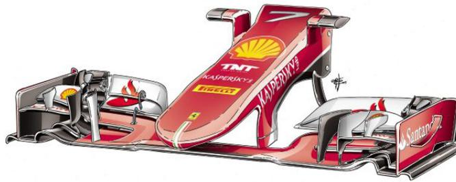
L'assenza dell'ala anteriore genererebbe un grande sottosterzo, ovvero quel fenomeno per il quale la macchina tende ad andare dritta in curva e non girare nella direzione in cui è diretto lo sterzo, questo per assenza di attrito tra pneumatico e asfalto. Aumentando la forza premente sugli pneumatici anteriori aumenta anche l'attrito, permettendo così alla vettura di girare.
